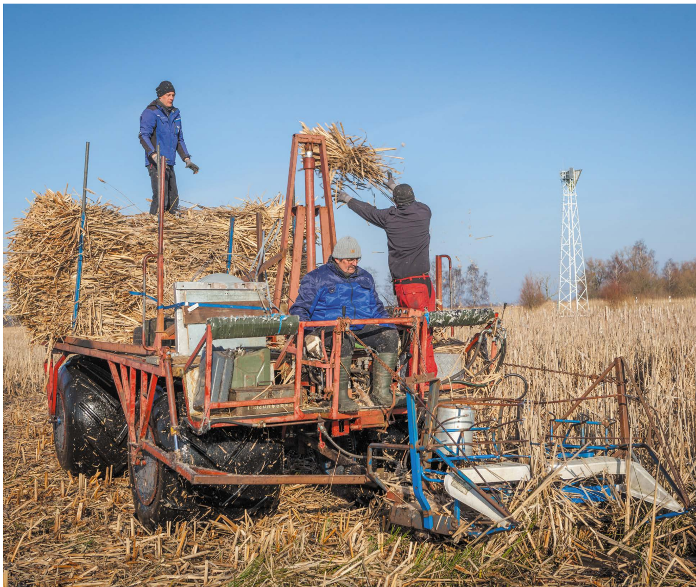
Rohrkolbenernte mit angepasster Technik im nassen Moor bei Anklam in Mecklenburg-Vorpommern. Die Biomasse wird als Einblasdämmung verwendet. Foto: Tobias Dahms
